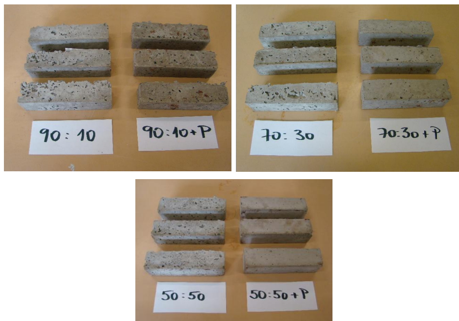
Obrázok 4 Porovnanie štruktúry vzoriek bez popolčeka a s popolčekom
