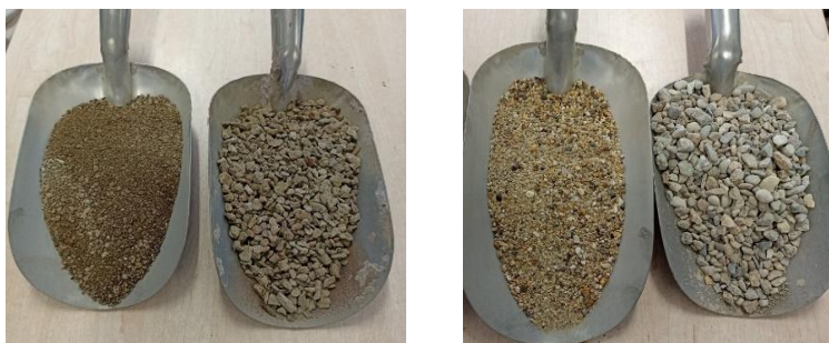
Obrázok 6 Vyťažené sedimenty z Ružína (vľavo) a prírodné ťažené kamenivo (vpravo) fr. 0/4 a 4/8 mm
