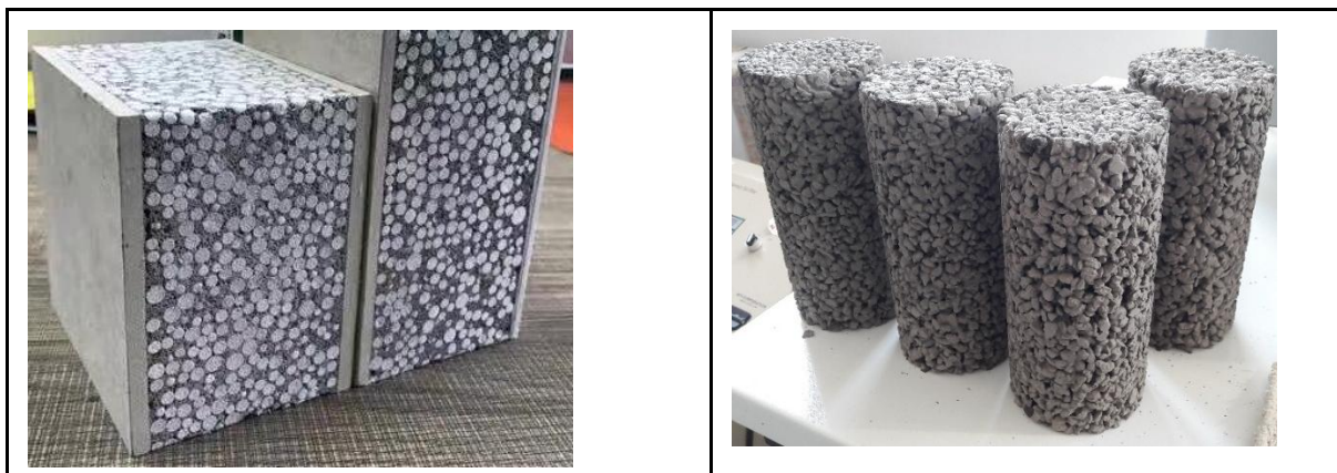
Obrázok 3 Príklady štruktúr ľahkých stavebných hmôt s alternatívnymi plnivami
